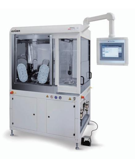
第二代萃取系统。用於檢查汽車零部件的技術清潔度,並根據 VDA 19.1第11章的建議進行了重新設計,以實現工作安全和 環境保護要求。RiuS Double 完全滿足您的要求。
